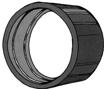
**1 –** Jestliže nelze pomocí GFK-dělených objímek dosáhnout potřebných průměrů pláštové trubky, je třeba použít redukčních kroužků. Těmito je možno pokrýt veškeré další průměry.
